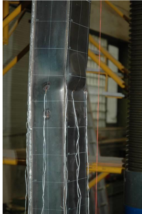
Abb.2: Gesamtstabilitätsversagen einer Hohlkastenstütze
