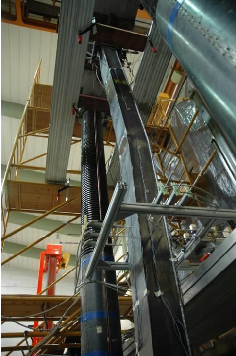
Abb.2: Gesamtstabilitätsversagen einer Hohlkastenstütze
