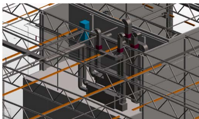
Bild 5. Referenziertes Stahlbau-Fachmodell im Koordinationsmodell (Planungshilfe für andere Gewerke, Kollisionskontrolle, etc.)
