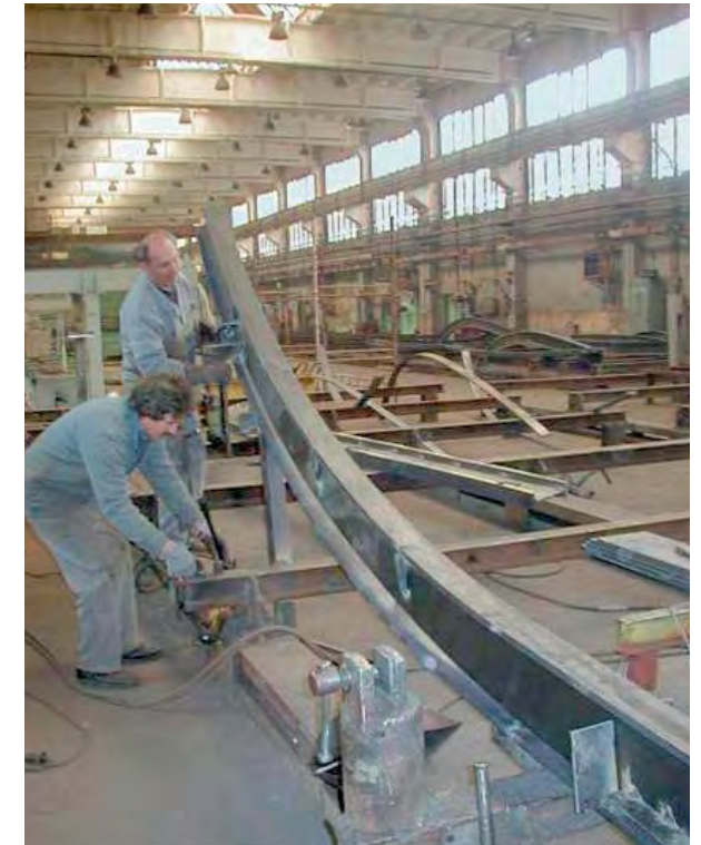
2.3 Fertigung der gekrümmten Stahlbauteile
