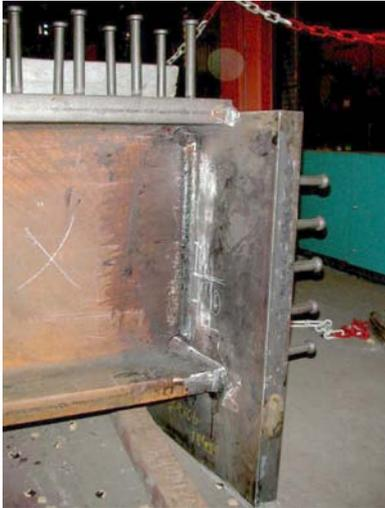
Bild 12: Detail mit angeschweißter Stirnplatte
