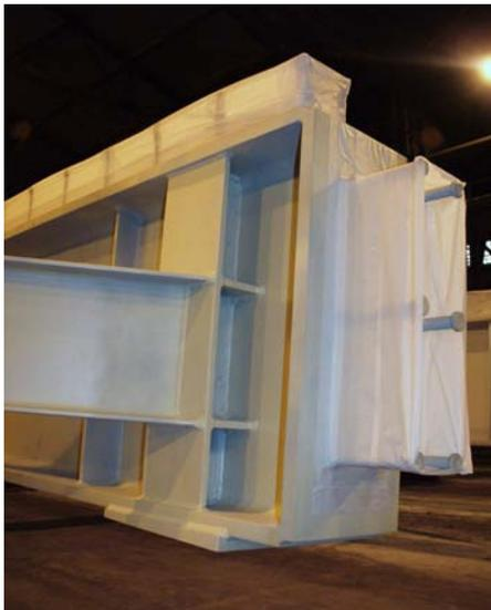
Zur horizontalen Aussteifung im Feld werden in der Regel Stahlquerträger vorgesehen. Dabei wird zwischen durch Schraubverbindungen und durch geschweißte Verbindungen mit den Längsträgern verbundenen Querträgern unterschieden, siehe Kapitel 6.3.4.
