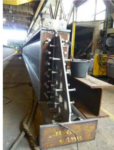
Bild 13: Detail mit am Unterflansch angeschweißter Druckverteilungsplatte
