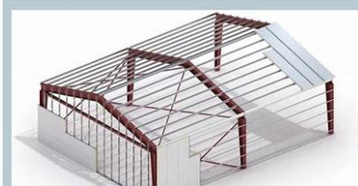
**Bild 1:** Sandwichelemente für Wand und Dach
