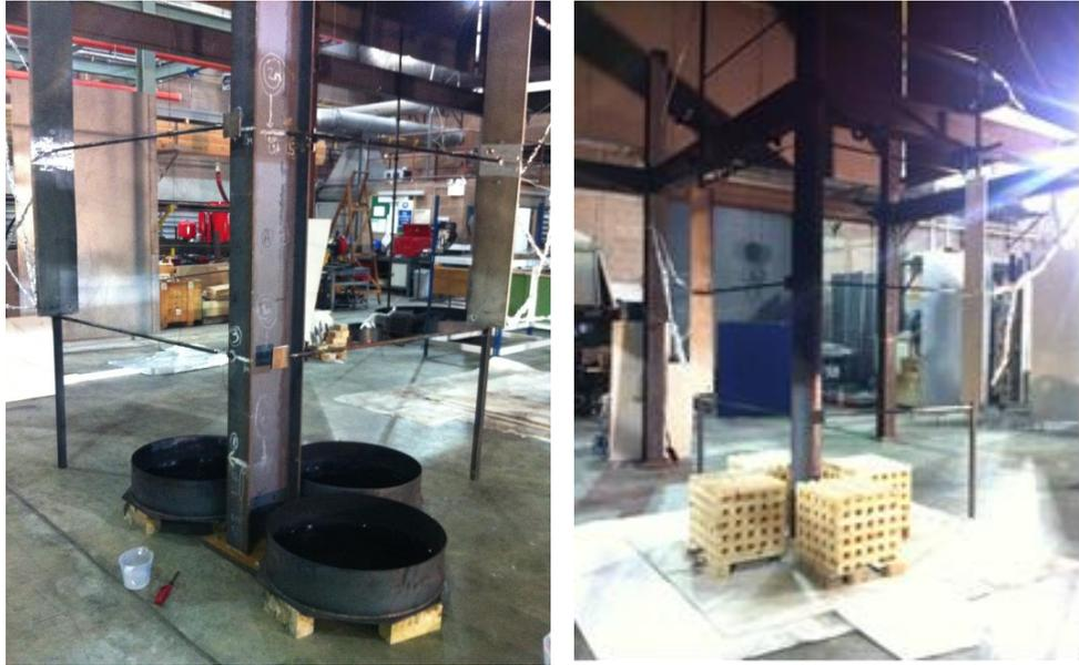
**Bild 3.4** Versuchsaufbau zur Untersuchung lokaler Brände bei FireSERT (links: Behälter für die flüssigen Brennstoffe, rechts: Holzgestelle)
