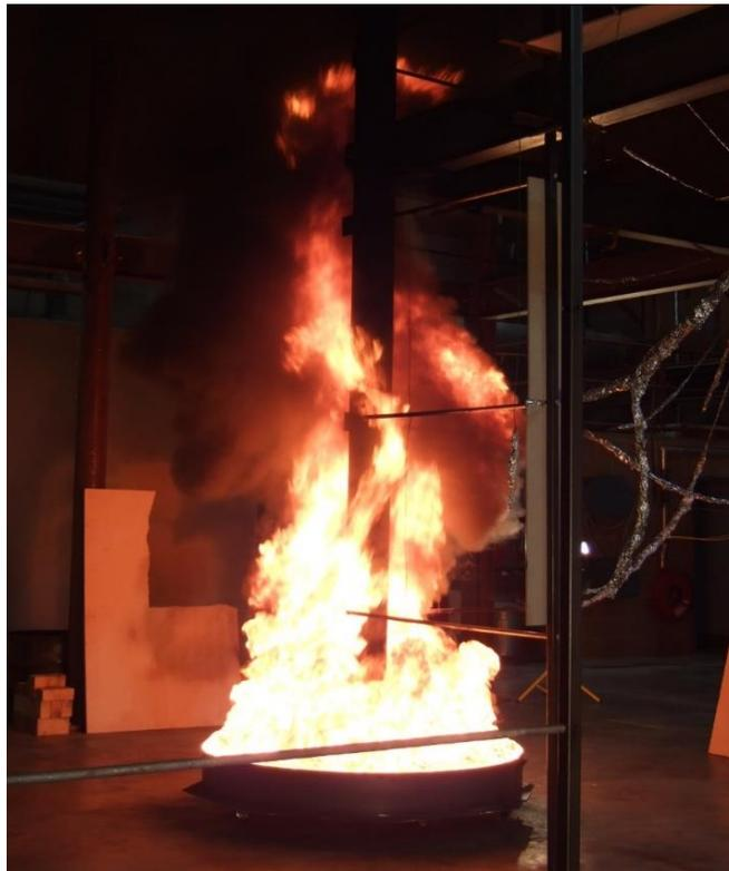
**Bild 3.1** Laborversuch an einer Stütze innerhalb eines lokalen Brandes
