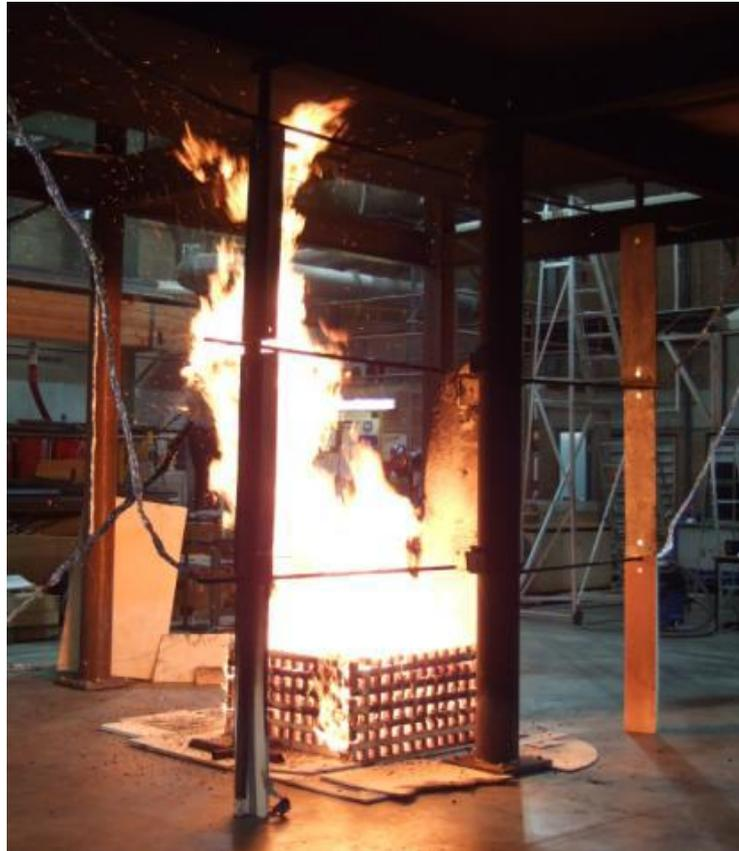
**Bild 3.7 Versuch O36, der Flammenkippen beweist**
