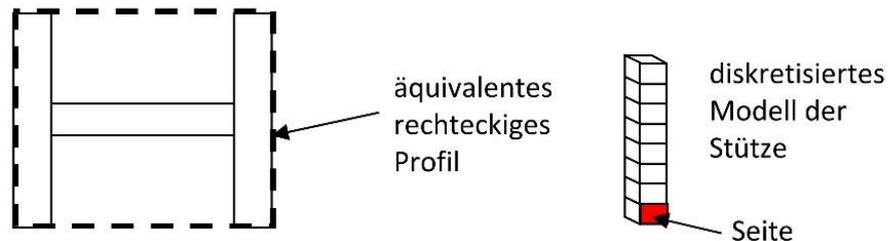
**Bild A.3 Modellierung einer H-Stütze und detaillierte Modellierung eines Segmentes**
