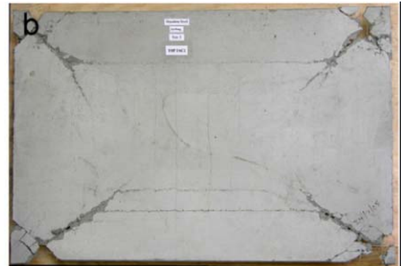
Druckbruch des Betons
